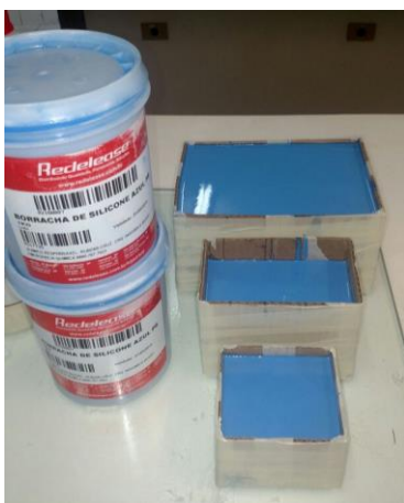
Figura 3. Formas confeccionadas com formas de papelão e silicone líquido.
